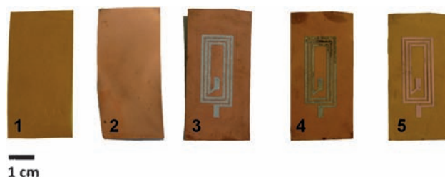
Abbildung 3. Aufnahmen der Substrate während des fünfstufigen Herstellungsprozesses des Leiterbahnmusters ausgehend von der mit Kupfer beschichteten Kaptonfolie: 1) Unbeschichtetes Kaptonsubstrat, 2) Substrat nach Kupferabscheidung, 3) Substrat nach Übertrag des mit einem Laserdrucker gedruckten Tonerusters auf die Kupferoberfläche, 4) Substrat nach dem Wegätzen des exponierten Kupfers, 5) Substrat nach dem Wegwaschen des Toners mit Aceton und das daraus resultierende Kupferleiterbahnmuster.
